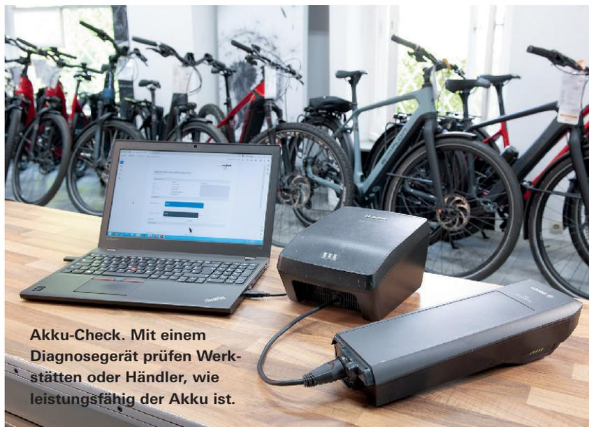
**Akku-Check.** Mit einem Diagnosegerät prüfen Werkstätten oder Händler, wie leistungsfähig der Akku ist.
